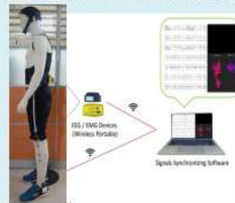
整合與同步生理及步態訊號系統架構圖
